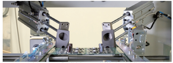
倒角板、正面和背面的角加工不同的基板也可准确的停止
